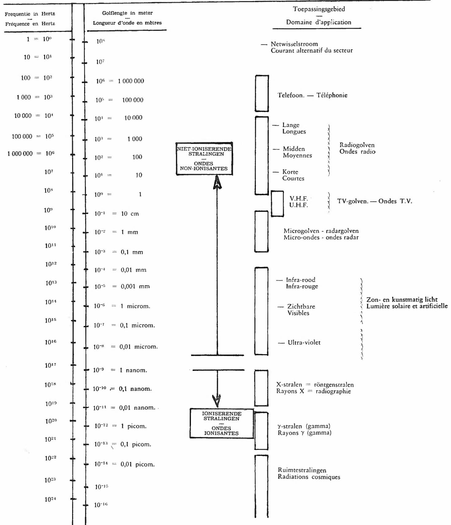
1) De ioniserende elektromagnetische golven (ioniserende stralingen) veroorzaken door hun contact met de materie de vorming van ionen (positief of negatief geladen atomen of moleculen), en deze reageren ten overstaan van hun omgeving op een verschillende manier dan neutrale atomen.
