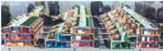
BEDZED ; Beddington UK : Le modèle architectural et urbanistique de BedZED a permis d'obtenir une densité de 105 logements et 200 bureaux par hectare (excepté la surface des terrains de sport), tout en respectant une hauteur de construction de 3 étages maximum. La forte densité du centre du quartier -où 500 personnes habitent et travaillent par hectare- a été obtenue grâce à l'intégration architecturale des espaces d'habitation (façade sud des immeubles) et des espaces de travail (façades nord).
