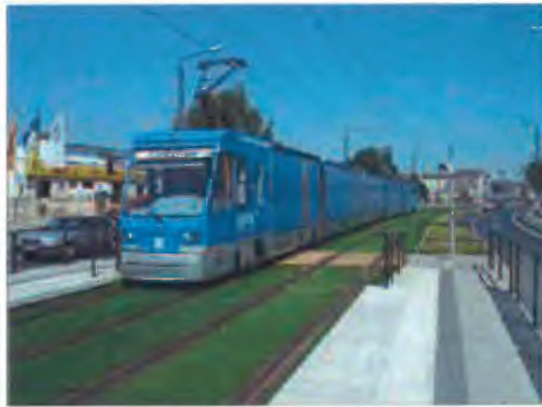
CarGoTram (Dresde, DE): le CarGoTram est un tramway de transport de fret à Dresde. Il approvisionne une usine Volkswagen avec des pièces pour la construction d'automobiles. Un train complet peut transporter l'équivalent du chargement de trois camions (214 m³).
